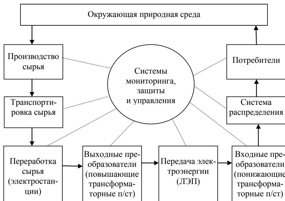
Рис.1. Логистическая сеть продвижения энергетического потока в системах традиционной энергетики
